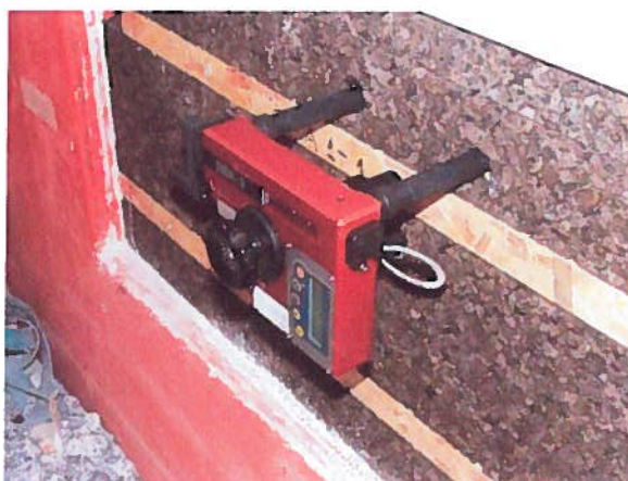
Figura 18. Equipamento de ensaio de pull-off montado na área 1 do provete
