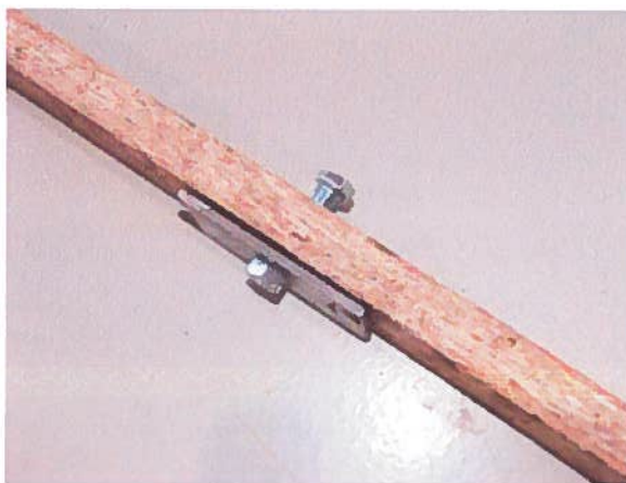
Figura 17. Acessório para a aplicação da força de arrancamento
